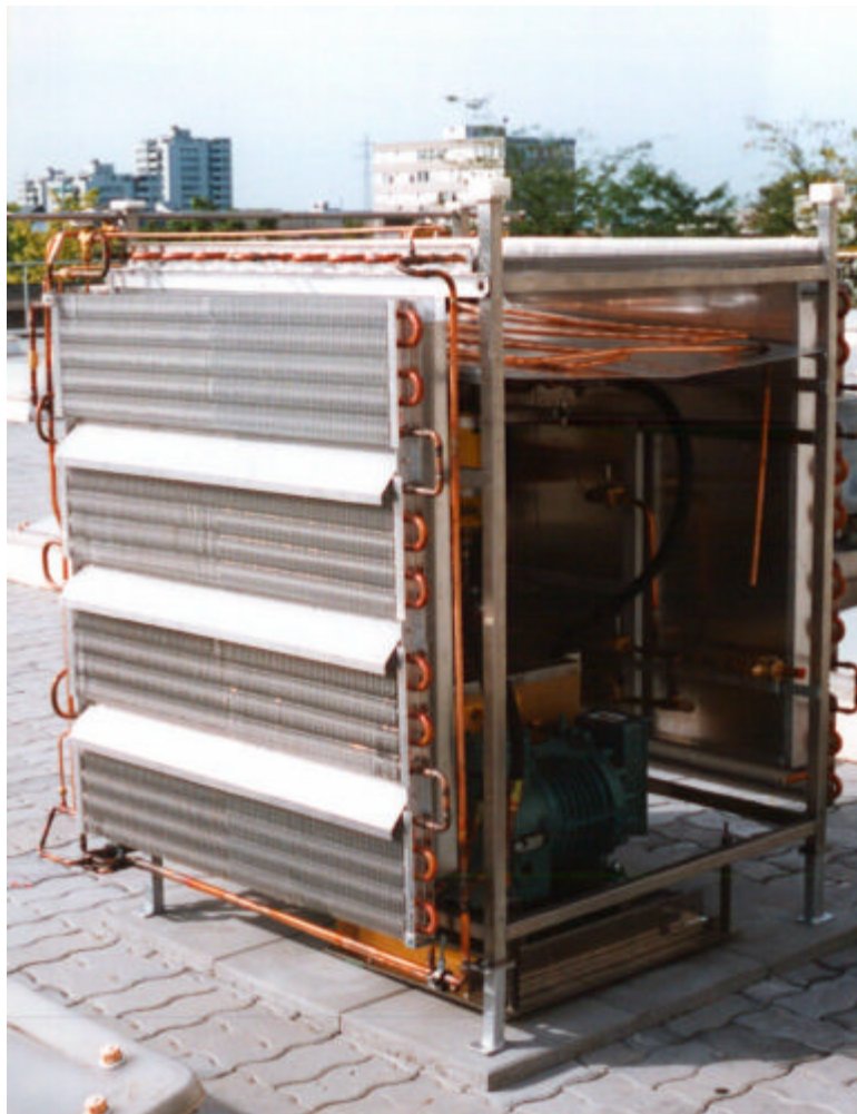
Bild 3: Funktionsmuster einer Luft-Wasser-Wärmepumpe mit stillem Verdampfer (aus [1]).
