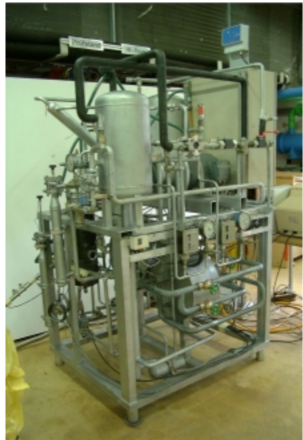
Bild 2: Funktionsmuster einer Kleinwärmepumpe mit Ammoniak als Kältemittel, aus [9].
